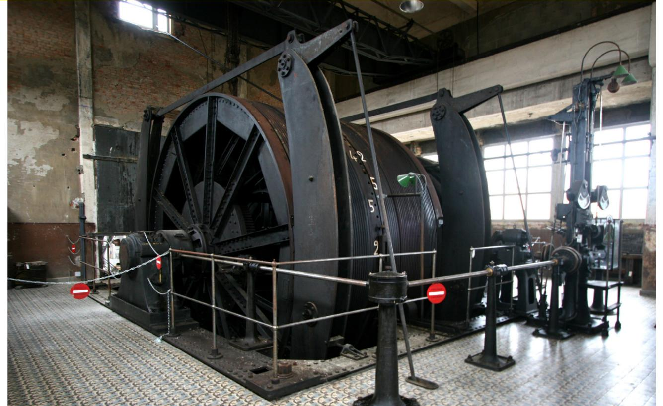
LE TAMBOUR DE LA MACHINE D'EXTRACTION : PERMET LA MONTÉE ET LA DESCENTE DE LA CAGE DANS LE PUIITS
